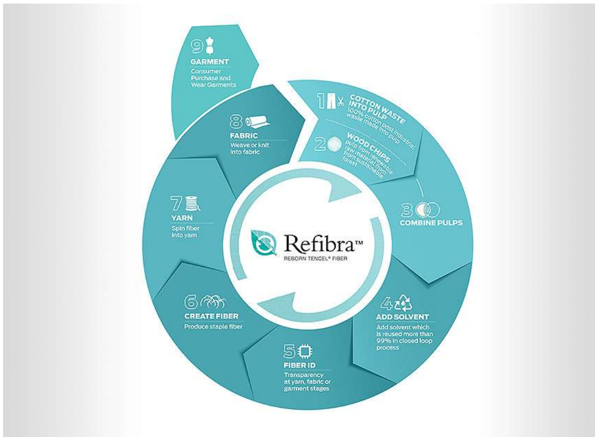
[그림 2-56] Lenzing사의 재활용 의류 데님 제품인 Refibra의 자원순환 생산과정
