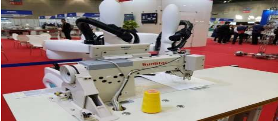
[그림 2-34] NT로봇과 썬스타의 협력 제품인 듀아로 SR(봉제 양팔로봇)
