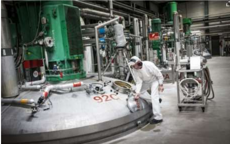
[그림 2-61] PET 플라스틱 분해 EPPM 효소 활용 해리(depolymerization) 공정
