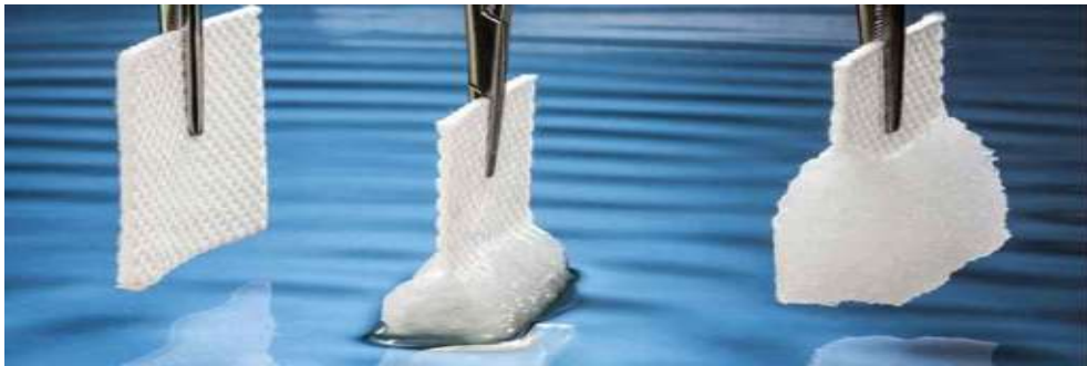
[그림 2-48] Freudenberg사의 Hydroactive 부직포의 진물 흡수 과정
