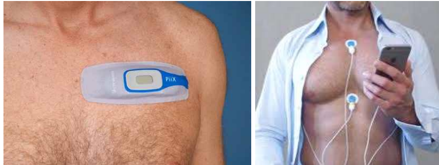
[그림 2-5-12] 부정맥을 측정하기 위한 심전도 측정계
